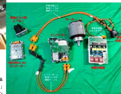
図2-2-7 ID.3の主な高電圧部品 出所:「フォルクスワーゲン「ID.3」徹底分解【全体編】」 第2章 パワートレイン
