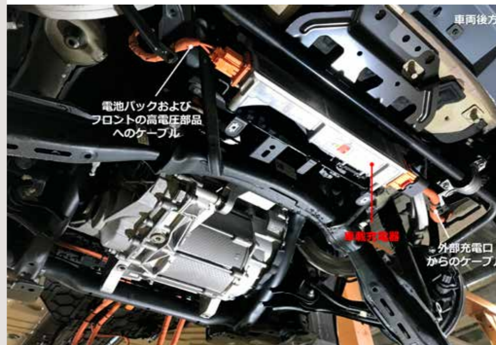
図2-3-1 ID.3の車載充電器は後方に配置 出所:「フォルクスワーゲン「ID.3」徹底分解【全体編】」 第2章 パワートレイン
