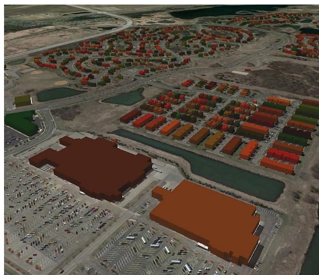
Google Earthでの2.5D表示例： 空中写真から抽出した建物と、州提供のLiDARデータによる3Dレンダリング（ミネソタ州スコット郡）
